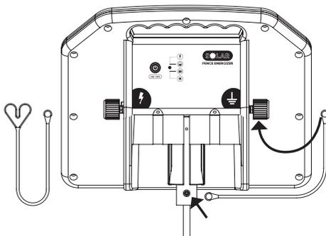
Očko uzemňovacího kabelu připojte na svorku uzemnění a připravenou díru montážní tyče.
