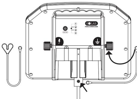
Podłącz końcówkę kabla uziemiającego do zacisku uziemiającego i przygotowanego otworu pręta montażowego.
